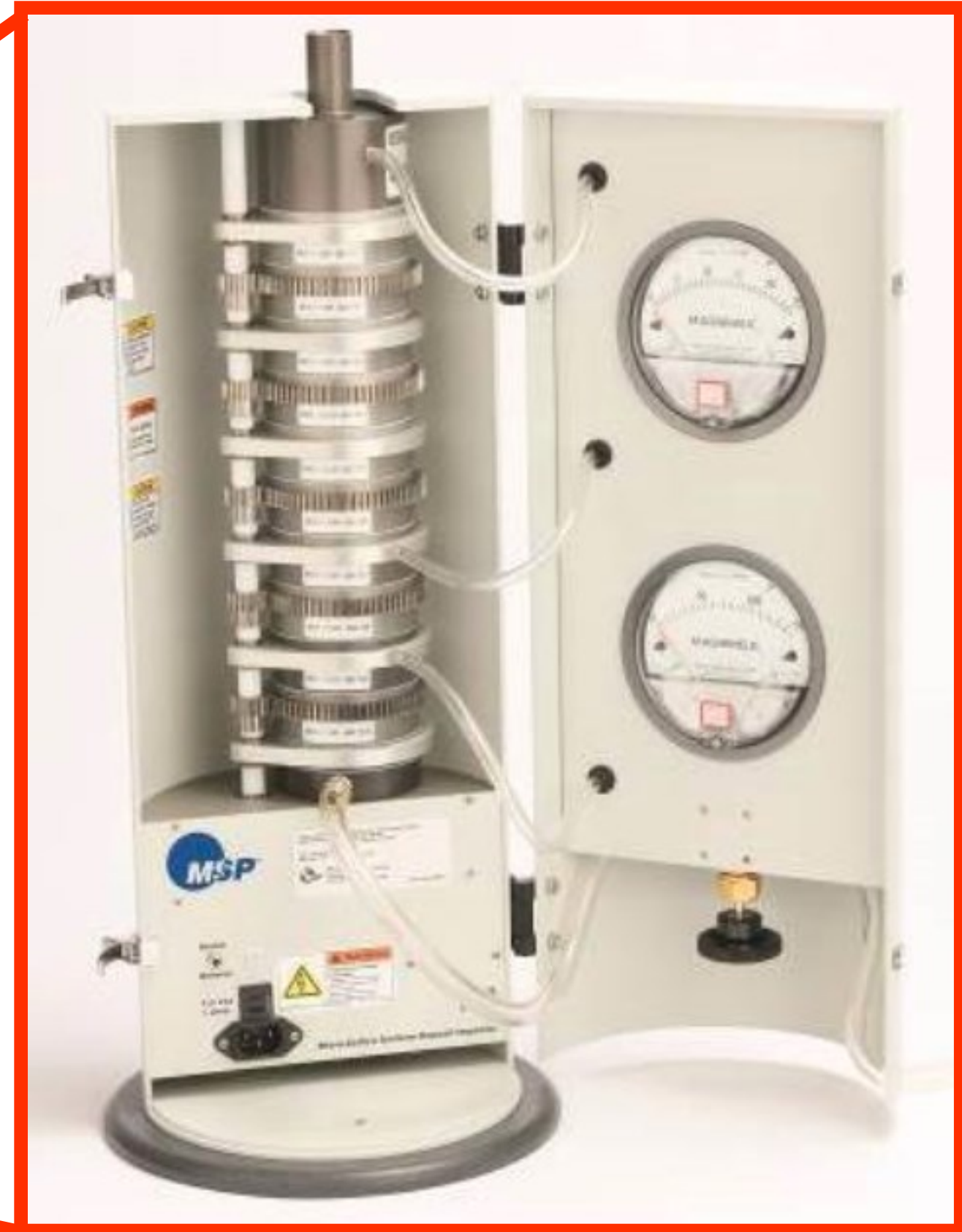
Figura 21. Impactador de depósito uniforme con microorificios (MOUDI). Tomada de https://tsi.com/getmedia/771ace7e-bda8-4f34-87ed-6c872ea98deb/MSP_MOUDI_Impactors_MSP_PI-100_US-web?ext=.pdf .
