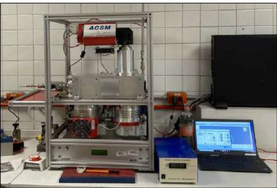
Monitor de especiación química de aerosoles ACSM , c/ 30 min
