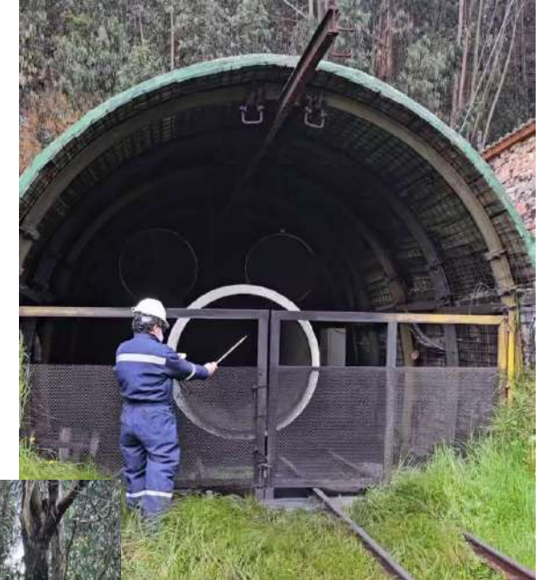
Medición de salida de aire de la bocamina (Mina A)
